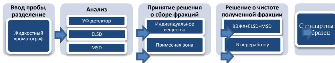
Рисунок 1. Принципиальная схема системы препаративного выделения
