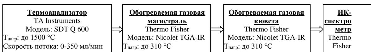
Рисунок 1 – Схема проведения ТГА-ИК анализа
