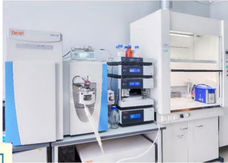
Хроматомасс-спектрометр высокого разрешения
